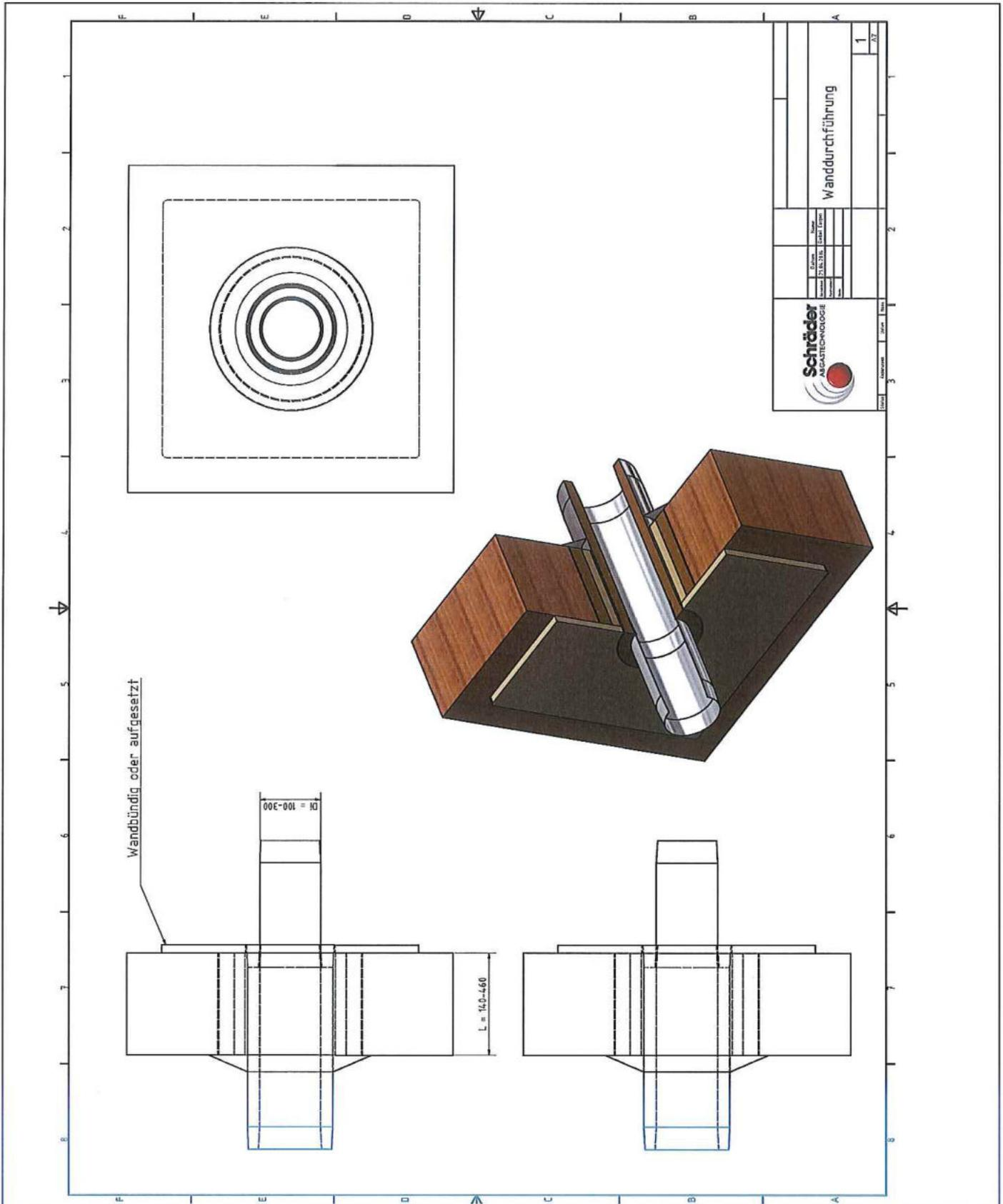
Bauelemente zur Herstellung von Wand-, Decken- und Dachdurchführungen von
